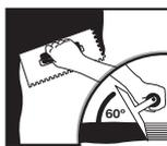
1. Estender a argamassa sobre a base, com o lado liso da desempenadeira e em seguida passar o lado denteado em ângulo de 60° para formar os cordões de assentamento. Devolver a argamassa aderida na desempenadeira ao recipiente, misturar sem adicionar água e utilizar novamente.
