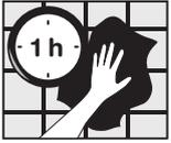
3. Até 1 hora após o início da aplicação, limpar a superfície do revestimento com pano levemente úmido para remover os resíduos de produto sobre a peça.
