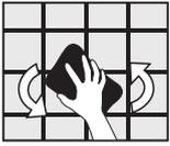
2. Com o auxílio de uma esponja levemente umedecida em água limpa, executar o acabamento com movimentos circulares até que as juntas fiquem lisas e no mesmo nível das bordas da peça. Trocar constantemente a água durante essa operação, mantendo a esponja sempre limpa.
