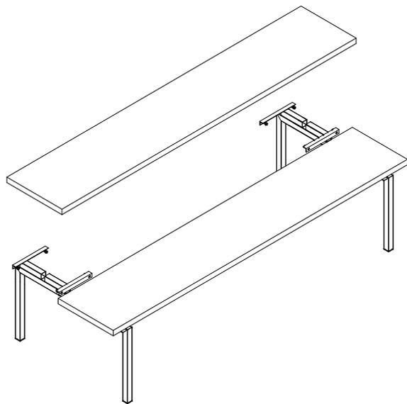
03. Para o posicionamento do segundo tampo, duas pessoas devem segurar cada cabeceira e posicionar sobre o lado da mesa faltante. Alinhe as furações e faça a fixação com os parafusos e arruelas.
