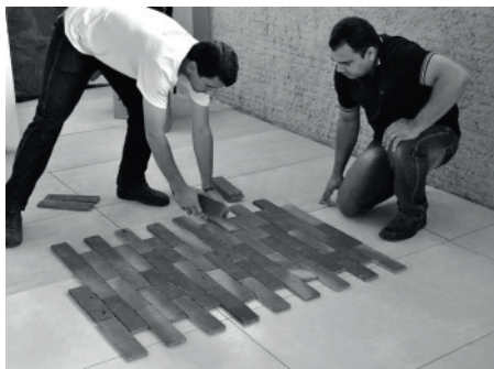
Foto 03: Montagem do painel com as placas para realização da inspeção
