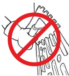
Ilustração 03: Cordões irregulares realizados com o auxílio da desempenadeira.
