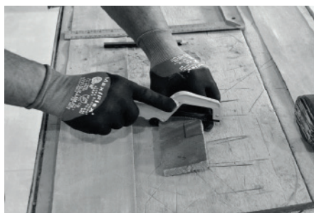
Foto 15: Corte com serra manual de metal
