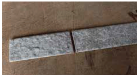
Foto 29: Acabamento corte realizado com riscador manual
