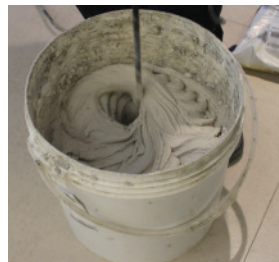
Foto 16: Mistura com haste helicoidal, formando uma pasta homogênea
