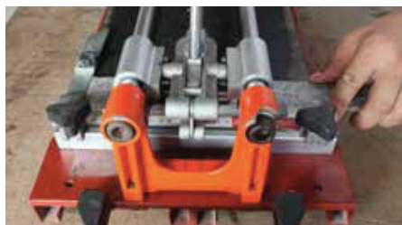
Foto 28: Corte realizado com Riscador manual com vídea
